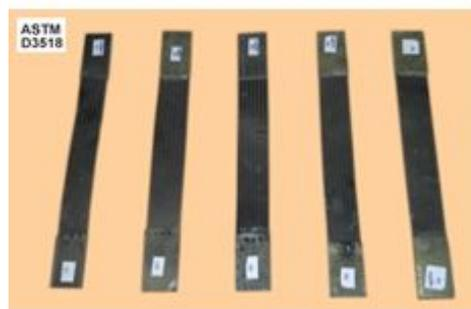
(d)CFRP  $\pm 45^\circ$  Coupon
